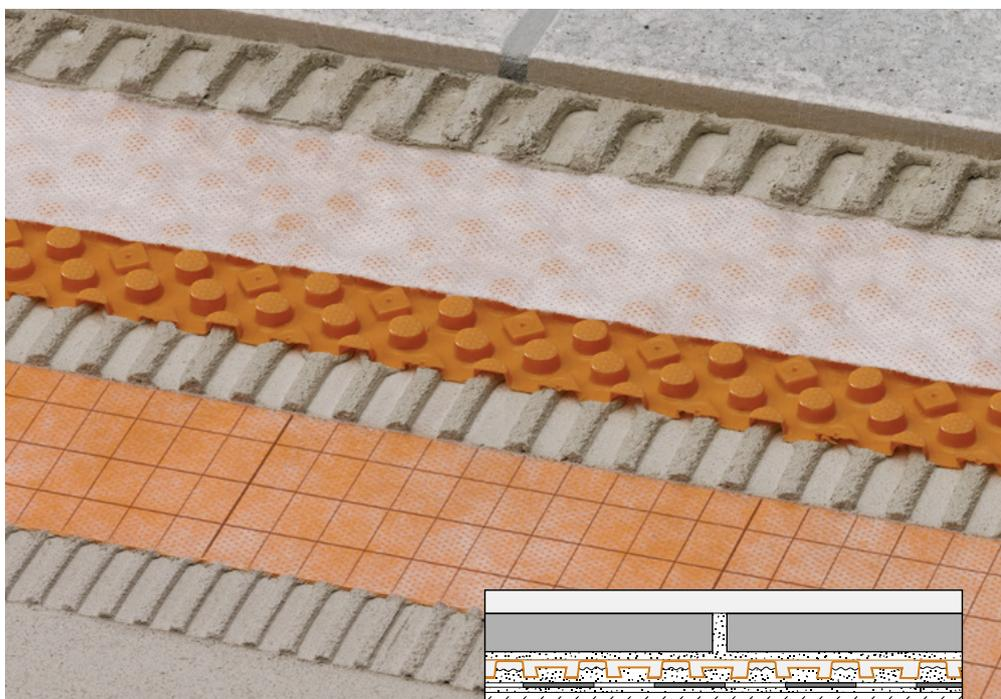
doit être déposé avec une spatule crantée (de préférence de 3 x 3 mm ou 4 x 4 mm) sur la protection à l'eau ou le support béton. Schlüter®-DITRA-DRAIN 8 doit être entièrement noyée dans la colle.
