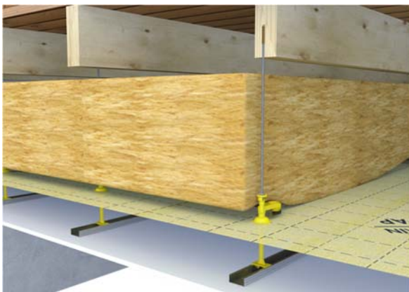
Figure 39 – Mise en œuvre en plafond du cavalier INTEGRA 2 et du clip plenum INTEGRA 2 avec un isolant en rouleau et la création d'un espace technique avec une rallonge INTEGRA 2
