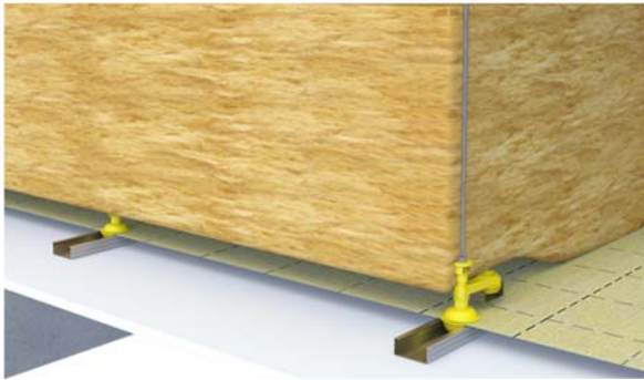
Figure 37 – Mise en œuvre en plafond du cavalier INTEGRA 2 et du clip plenum INTEGRA 2 avec un isolant en rouleau
