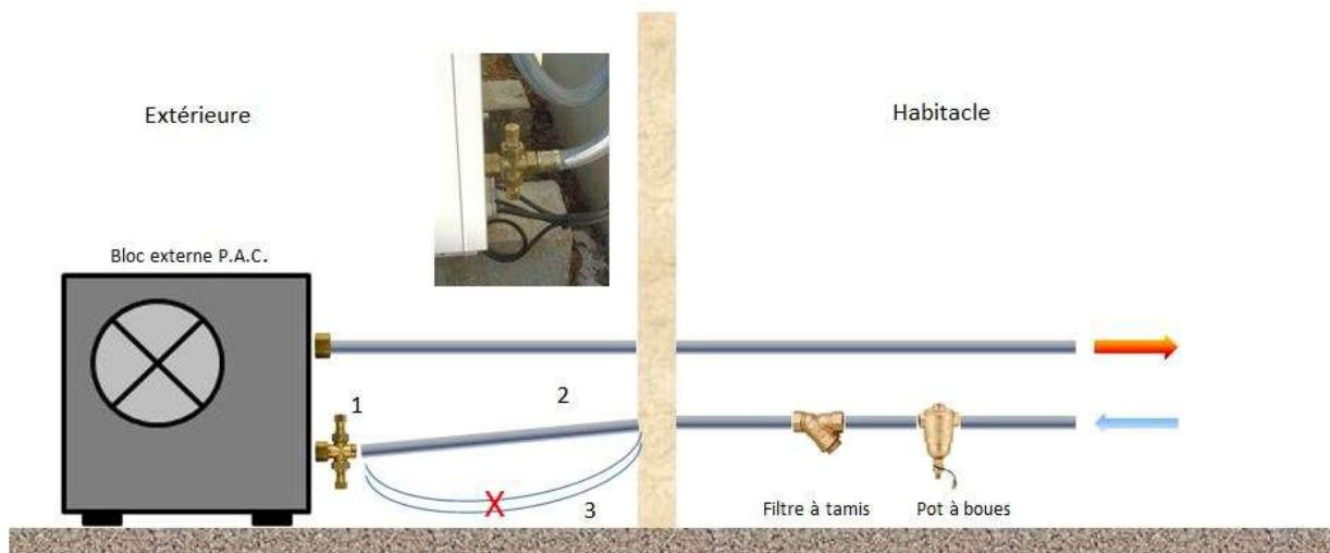
Dans le cas de coupure d'électricité par grand froid, grâce à **EXOGEL™**, votre installation ne peut pas geler. Nous préconisons de monter un groupe de remplissage automatique sur la canalisation pour que l'eau circule dans l'installation. Ainsi l'eau échappée sera remplacée, les canalisations de chauffage resteront en pression et le redémarrage se fera sans problème et sans intervention humaine. **Ne pas fermer de vanne lors de la période de gel !**
