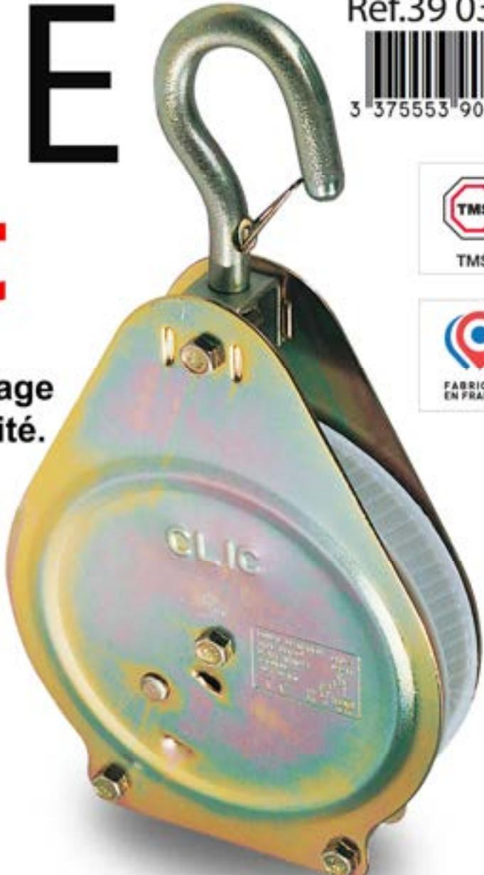
La poulie CLIC permet le levage de tous types de matériaux de construction, éléments d'échafaudage, etc... son système d'encliquetage vous permet de vous reprendre au cours du levage de la charge : lorsque vous cessez de tirer sur la corde, un cliquet bloque le réa ; sa gorge trapézoïdale freine le glissement de la corde, et vous pouvez « souffler » ; une nouvelle traction débloque le cliquet et vous pouvez continuer à hisser ou laisser descendre la charge.
