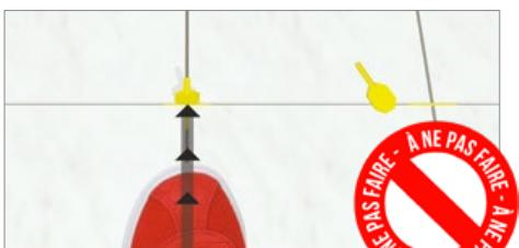
\* Un serrage trop intensif du cadran risque une rupture prématurée du croisillon.
